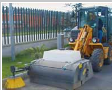
Spazzatrice con kit innaffiante e spazzola pulizia laterale (a richiesta) Polishing brush with watering kit and side brush (by request)
